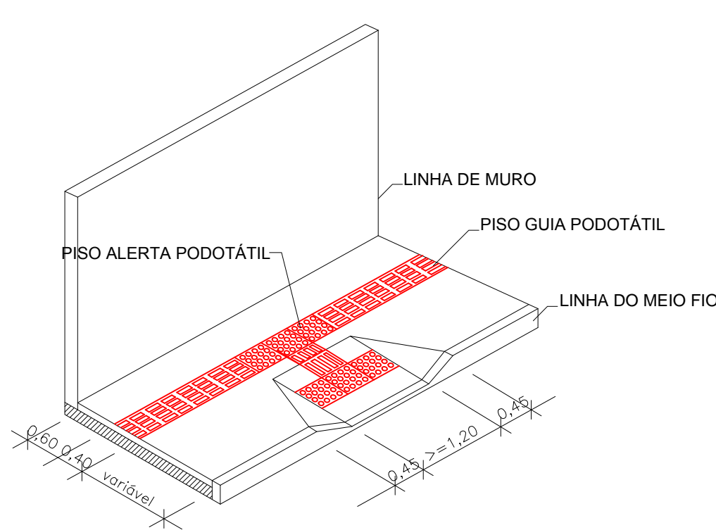
Detalhe padrão do rebaixo do passeio público para faixa de pedestres com piso podotátil. Quando passeio tiver largura >= 1,20 m.
