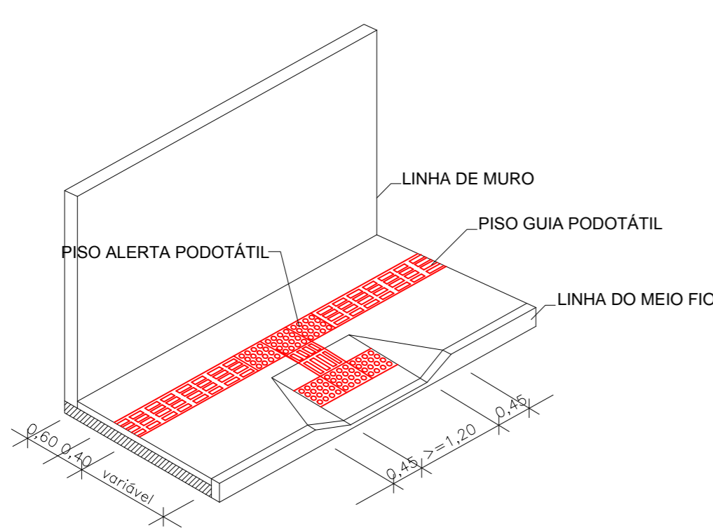
Detalhe padrão do rebaixo do passeio público para faixa de pedestres com piso podotátil. Quando passeio tiver largura \geq 1,20 m.
