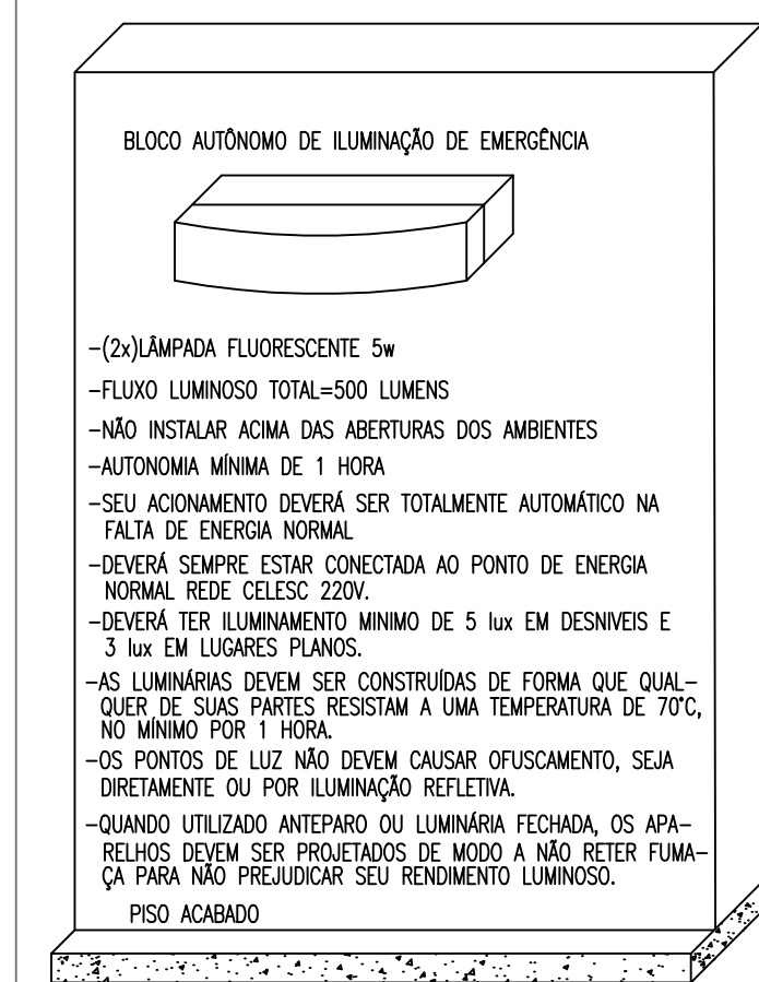
DETALHE DA LUMINÁRIA DE EMERGÊNCIA TIPO BLOCO AUTÔNOMO. S/ ESC.
