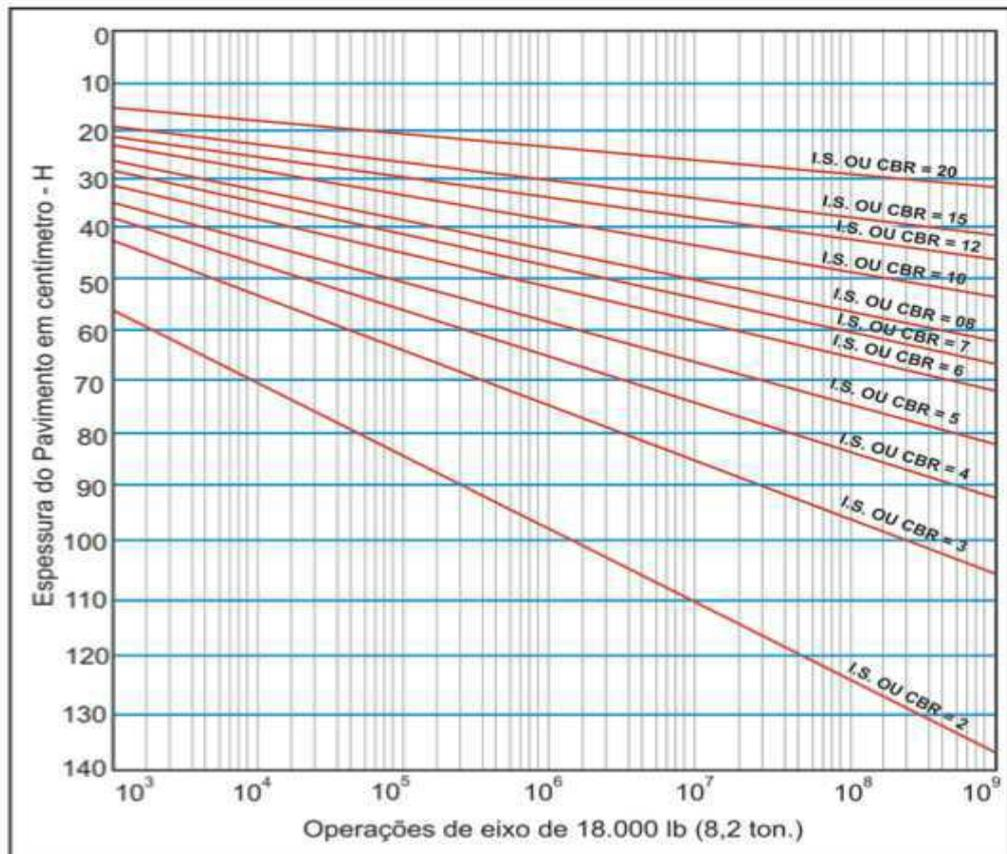
Figura 2 - Gráfico para Dimensionamento de Pavimento
