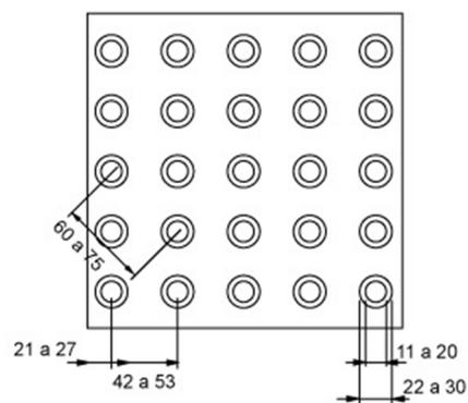
Figura 4 - Detalhamento do Piso podotátil alerta
