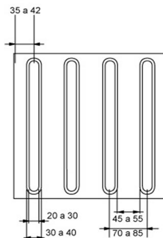
Figura 5 - Detalhamento do Piso podotátil direcional
