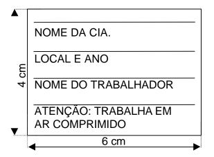
A placa deverá ser fabricada em alumínio com espessura de 2 mm.
